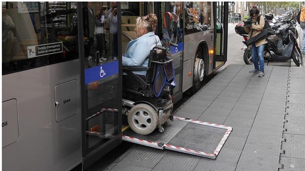
Imatge 4. Autobús de plataforma baixa i amb rampa de la xarxa de bus metropolità. Font: AMB
